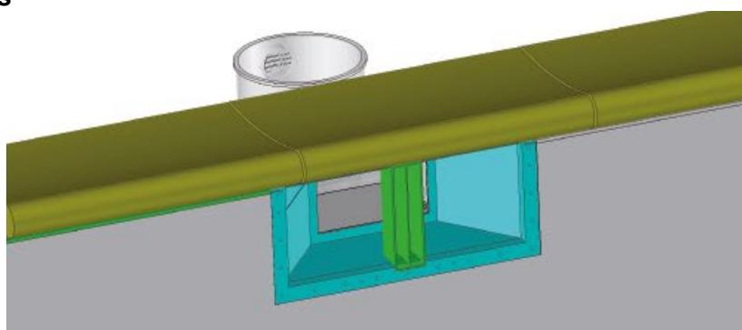
Sacar la calce de sostenimiento de la boca, solamente cuando el conjunto esté completamente seco.
