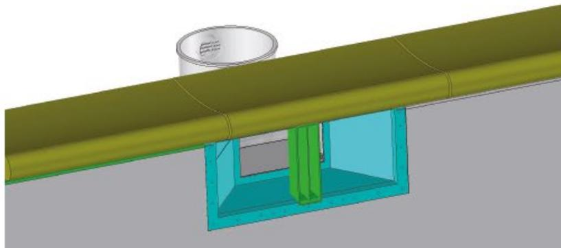
Entfernen Sie die Stützvorrichtung erst dann aus der Saugöffnung, wenn der Beton vollständig getrocknet ist.
