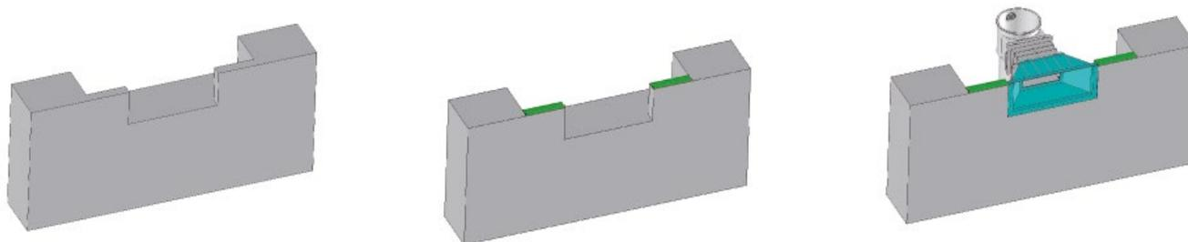
Le renfort inox est positionné sur les 2 morceaux de profilé Hung (juste derrière la partie crochet).
