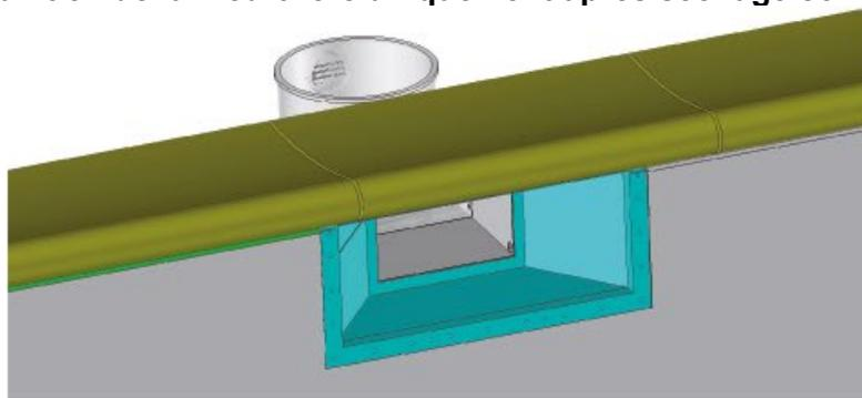
\* Mortier de réparation fibré à prise rapide avec fonction anticorrosion Classe R4 selon norme NF EN 1504-3 (type weber 11101251)
