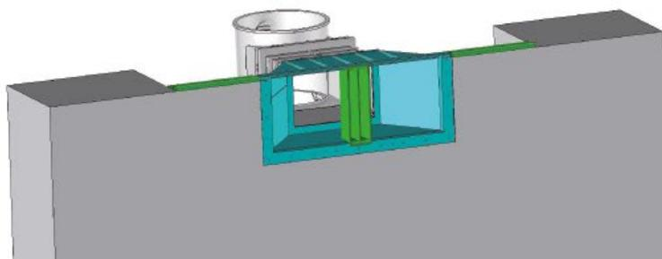
Platzieren Sie die Stahlarmerung; achten Sie darauf, dass deren Endpunkte mit dem Betonringanker des Beckens übereinstimmen.
