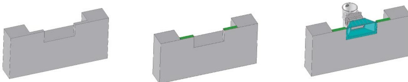
El refuerzo de inox se posiciona sobre los 2 trozos de perfil Hung (justo detrás de la parte gancho).
