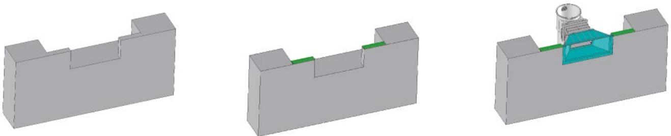
Die Edelstahlverstärkung wird auf 2 Längen des Klemmprofils Hung platziert (unmittelbar neben der Einhängeleiste - Ausschnitt im Skimmer).
