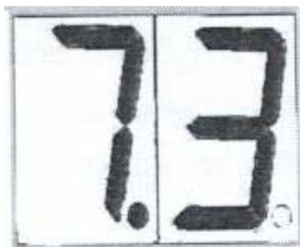
Im Laufe der einzelnen Funktionen wird der gemessene pH Wert auf dem Display angezeigt. Die Funktionen der Pumpe sind proportional mit dem Proportionsintervall von pH 1,0 und der Maximalanzahl von 160 Impulsen pro Minute
