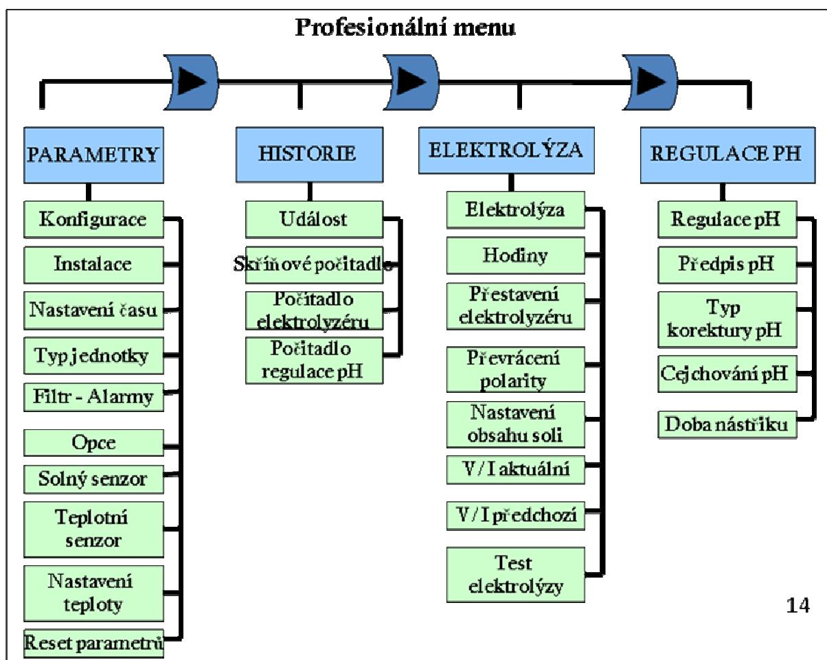
**Nastavení teploty** – teplotu nastavíte Profi menu → Parametry → Nastavení teploty (Temp. ADJUSTMENT) → zde nestavte teplotu, kterou jste naměřili v bazénové vodě a potvrďte stisknutím OK.
