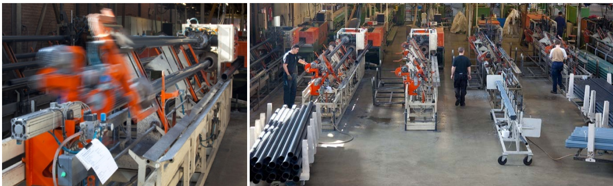
Pro výrobu trubek PVC se používá materiál PVC-U (polyvinylchlorid bez obsahu změkčovadel).
